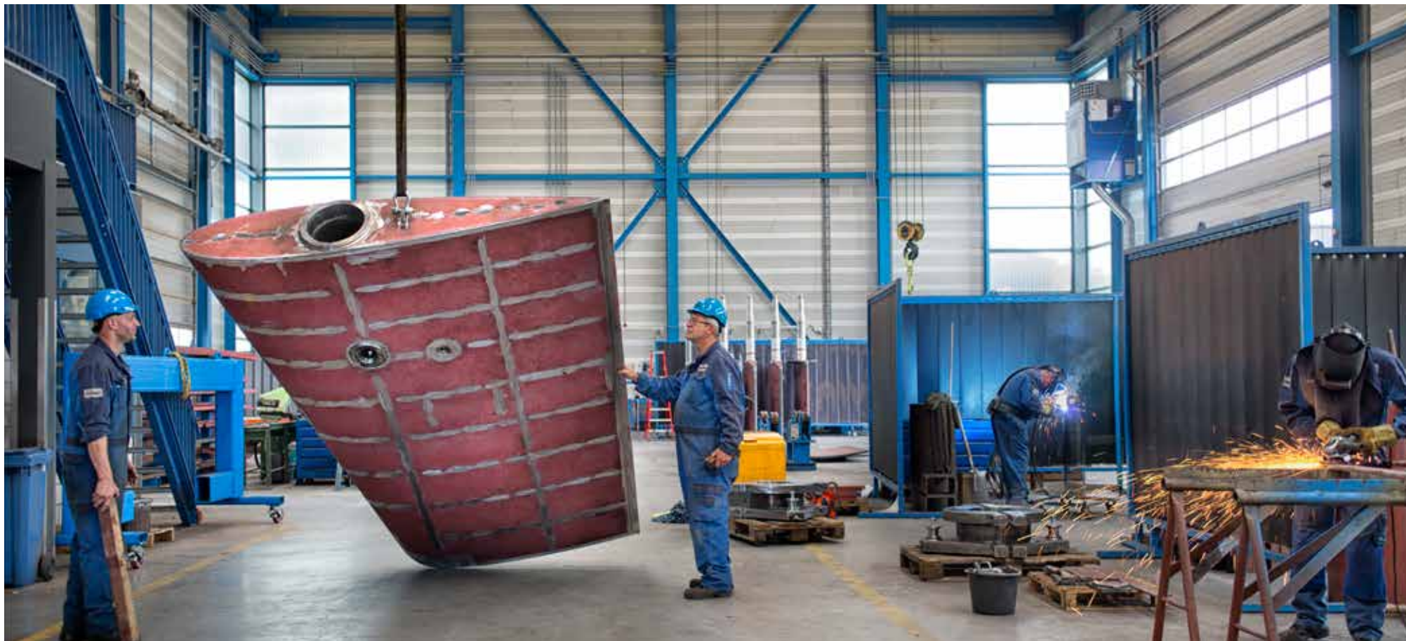
Naca profielroer voor een 110 meter superjacht. De Waal bouwt meerdere van deze 'hoge snelheid jachtroeren' voor een bekende werf.
